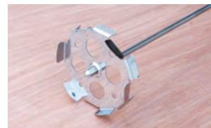
攪拌機 1,300rpm リシン羽根
