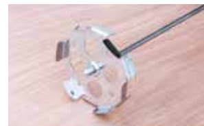
攪拌機 1,300rpm リシン羽根
